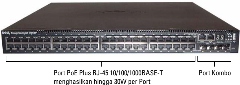
Gambar 1-5. PowerConnect 7048P dengan 48 Port PoE Plus 10/100/1000BASE-T
